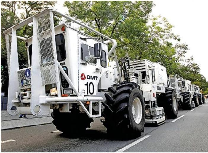
Seismik-Fahrzeuge zur Untergrunduntersuchung (Quelle: SWM.de)
